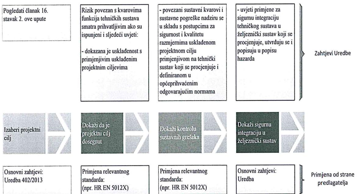
Slika 3: Postupak provjere prihvatljivosti rizika povezanih sa kvarovima funkcija tehničkih sustava i značaj pojma usklađenost
